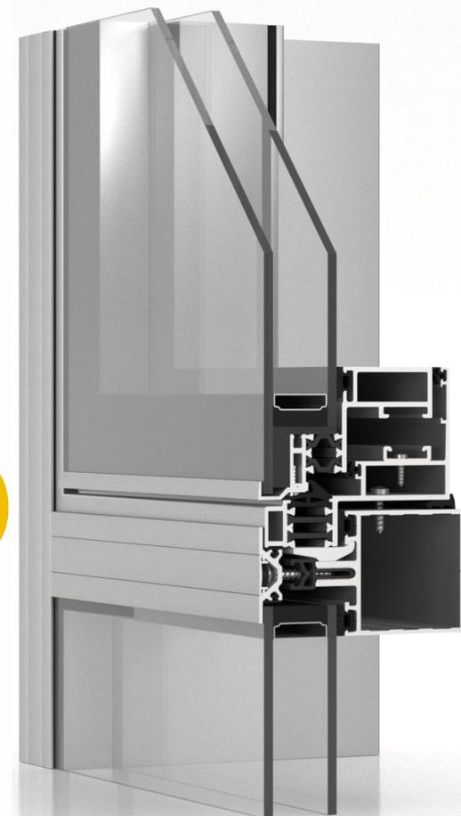
Серия верхнеподвесных окон ALT 83 предназначена для изготовления оконных блоков с наружным открыванием створок, интегрируемых в ограждающие конструкции наружной архитектурной застройки зданий, к которым предъявляются требования термоизоляции. Основу серии составляют комбинированные профили, состоящие из двух алюминиевых профилей, соединенных между собой с помощью двух термовставок из полиамида.
