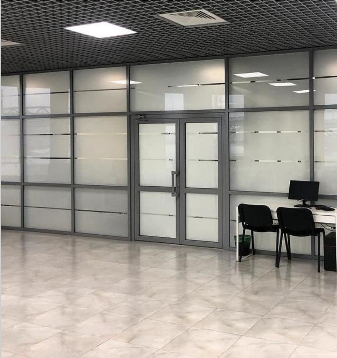
Система предназначена для изготовления конструкций, которые устанавливаются внутри помещения или в неотапливаемых помещениях.
