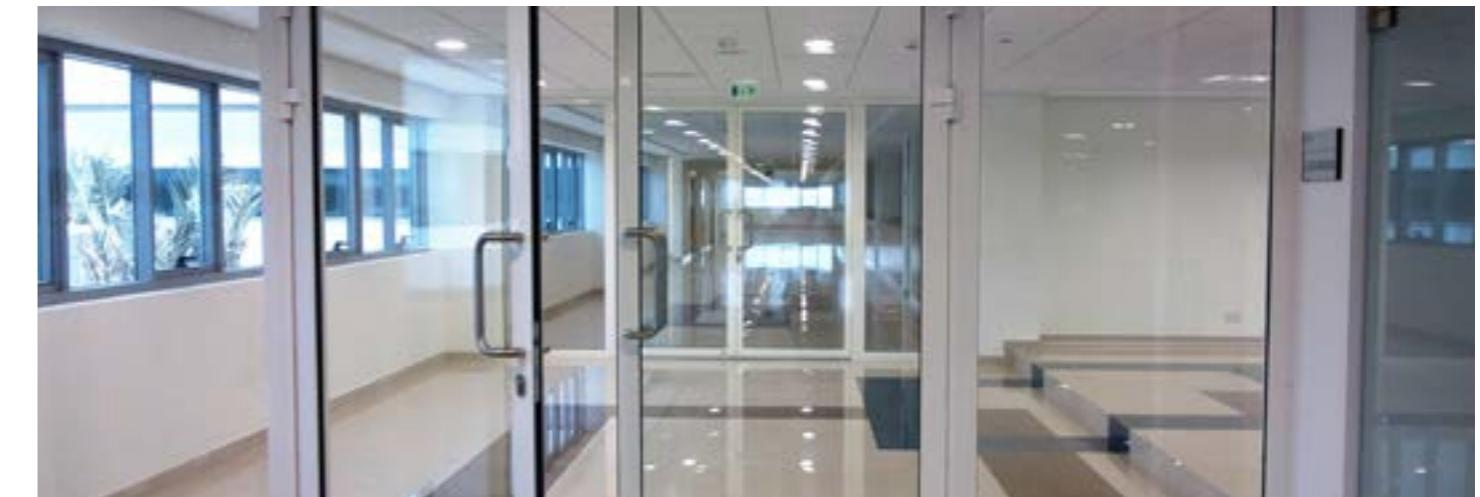
AL 40 - это дверная серия профилей без терморазрыва, которая предназначена для изготовления конструкций, которые устанавливаются внутри помещения или в неотапливаемых помещениях.
