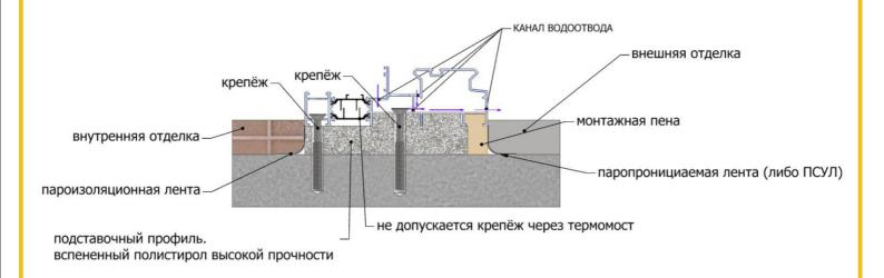
Примечание – Монтажу изделий предшествует приемка проемов: кромки и поверхности наружных и внутренних проемов не должны иметь выколов, раковин, наплывов раствора и других повреждений высотой (глубиной) более 10 мм. В общем случае монтажные швы узлов примыканий блоков к стеновым проемам должны включать следующие функциональные слои:
